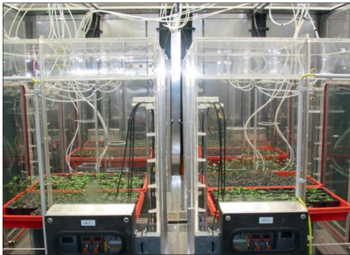
Expositionskammern für die Experimente zur NO-Behandlung.
